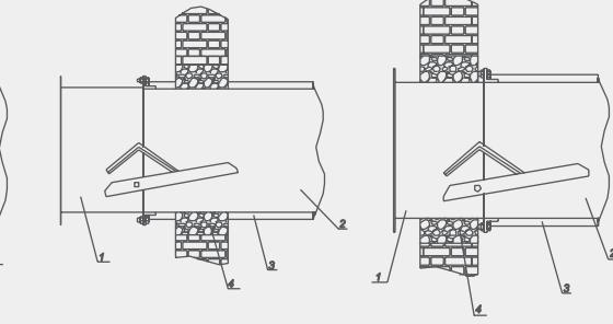
Схема установки в вертикальной конструкции
