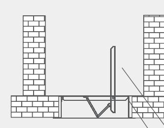
Схема установки в воздуховоде
