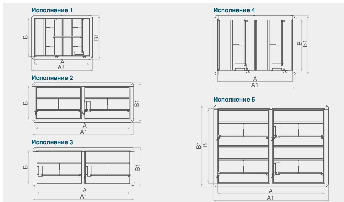
Канальные клапаны КДМ-2м с приводом снаружи во 2 исполнении комплектуются двумя приводами.
