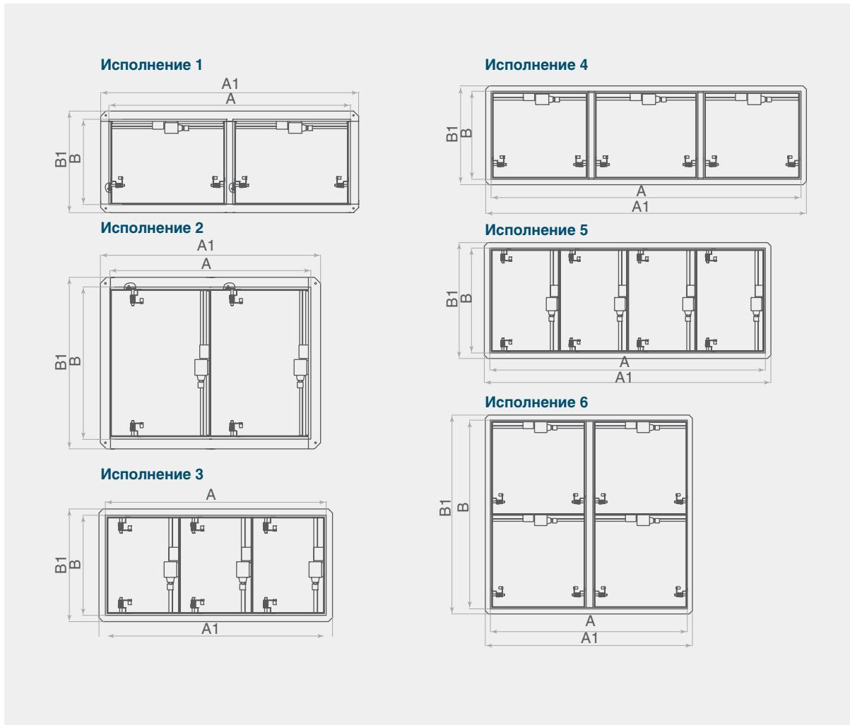
Типоразмерный ряд и значение площади проходного сечения клапанов DKS(КДМ-2м) с электромагнитным приводом, м<sup>2</sup>
